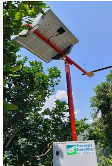
Estación de transmisión de datos vía Celular, a página web Aquatic.com.co
